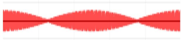
**Abb. 4:** Addition der Amplituden eines Tones mit Frequenz 440 Hz und eines Tones mit der Frequenz 442 Hz für eine Sekunde
