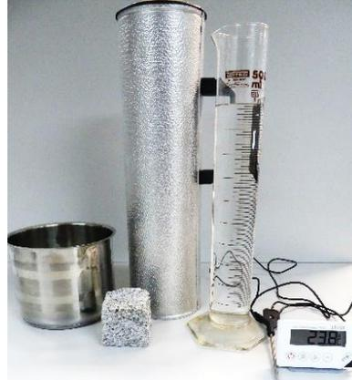
Abb. 2: Experiment Wärmekapazität von Gestein (eigene Darstellung)
