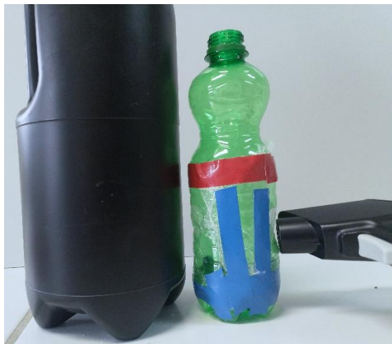
Abb. 9: Temperaturmessung durch Treibhausflasche (eigene Darstellung)
