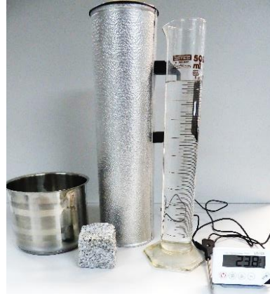
Abb. 2: Experiment Wärmekapazität von Gestein (eigene Darstellung)
