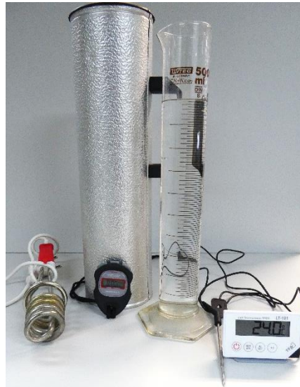
Abb. 1 Experiment Wärmekapazität Wasser (eigene Darstellung)
