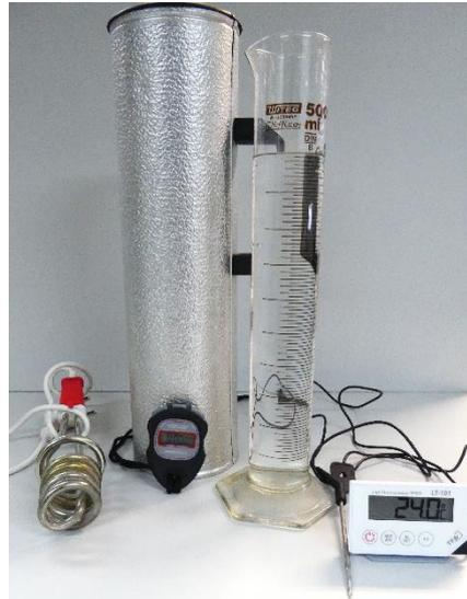
Abb. 1 Experiment Wärmekapazität Wasser (eigene Darstellung)
